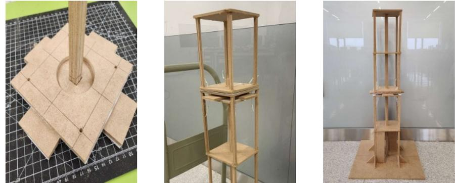
관성력으로 저층부 및 지반과 분리되도록 마찰 플레이트를 이용한 면진 장치 구현
