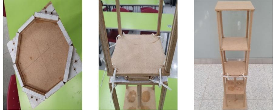
계면마찰로 지진에너지를 감소시키도록 마찰 플레이트를 이용한 제진 장치 구현
