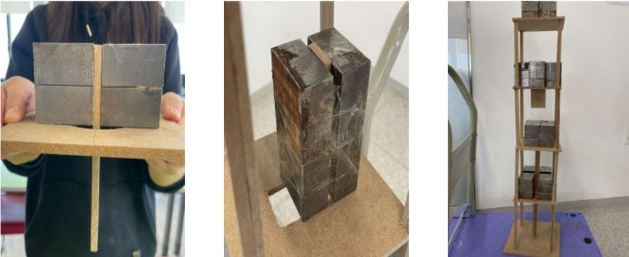
관성력으로 지진과 반대 방향으로 구조물이 거동하도록, TMD를 응용한 제진 장치 구현
