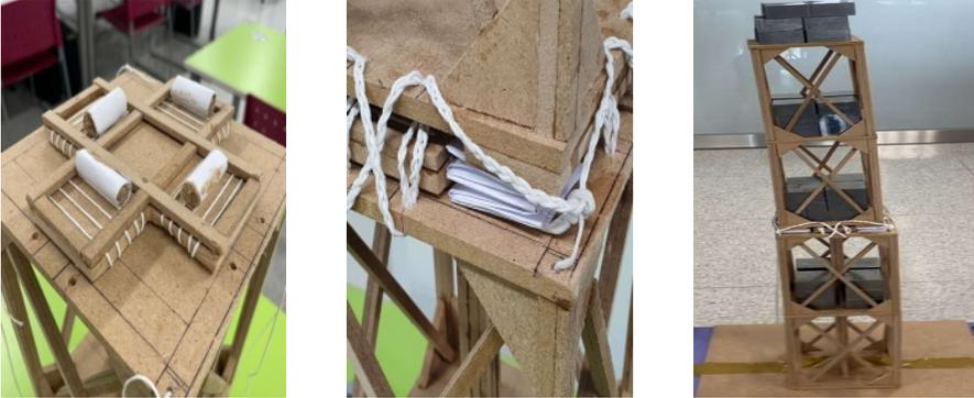
응답변위를 증가시키는 대신 응답가속도를 감소시키고자, 롤러를 이용한 면진 장치 구현
