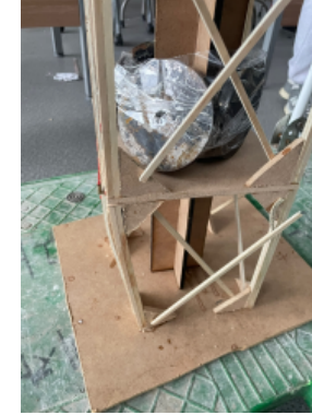
1층 기둥과 가새 파손
