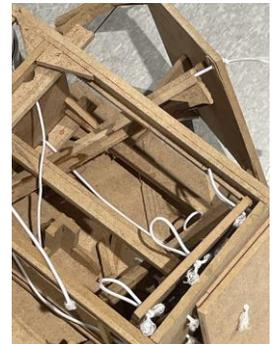
➤ 진동 실험 결과 0.6g까지는 구조 부재 탈락 또는 손상이 발생하지 않음. 약 0.7g에서 상부 구조물이 수평 방향으로 크게 움직임. 하부 구조물과 위상차가 커지면서 2, 3층을 연결하는 고무줄이 빠져 붕괴 발생. 최종 설계안 확정
