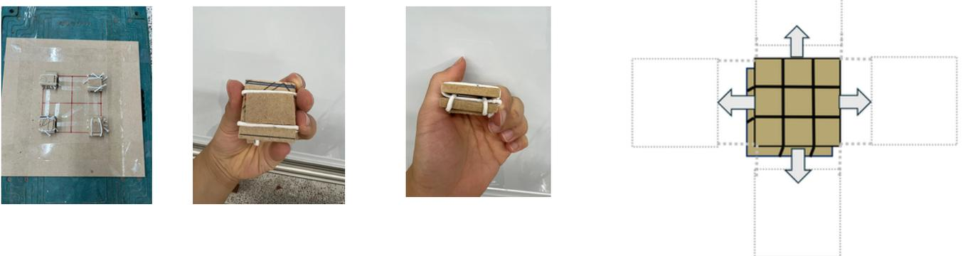
면진장치를 구조물의 모서리로 배치하여 구조물의 압축력과 하중을 분산시켜 밸런스를 잡아주며 그물모양의 면진장치는 4방위 즉 지진파의 수평방향에서 자유롭게 반응할 수 있으며 스트링 고무줄을 활용하여 높은 탄성과 복원력으로 과도한 움직임에도 이탈을 방지한다. 또한 고무줄의 지름 2-3mm 보다 높은 두께의 6mm 슬래브 판을 덧 붙여 접착력을 향상시키며 고무줄의 움직임에 걸림돌없이 면진성능을 증진시킨다.
