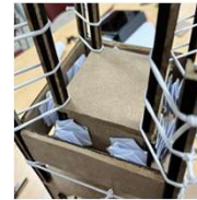
<종이 댐퍼 & 고무줄 장치 설치>
