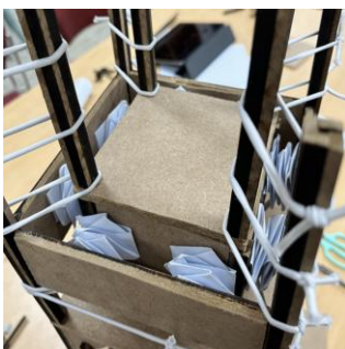
<종이 댐퍼 & 고무줄 장치 설치>
